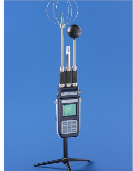
Tutte le sonde SICRAM possono essere inserite in uno qualunque degli ingressi; vengono riconosciute automaticamente all'accensione dello strumento.
